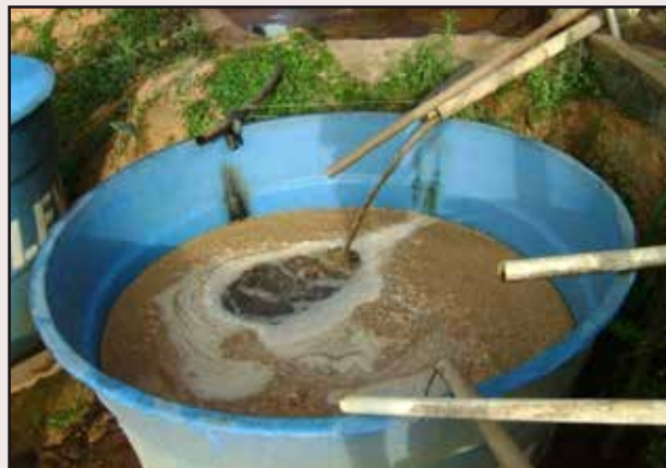
Sistema de reciclagem de água residual do despulpamento do café. (Fonte: Universidade do Café Brasil - Illy)
