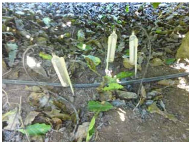
Figura 22: Tensiômetros utilizados no manejo da irrigação. (Fonte: Eduardo Matavelli)
